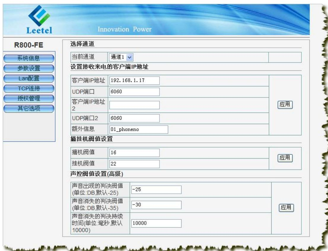
图 2 在设备 WEB 中设置要接收来电的客户端 IP 地址和端口
